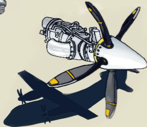
——动力涡轮带动螺旋桨的发动机，被称为涡桨发动机。
